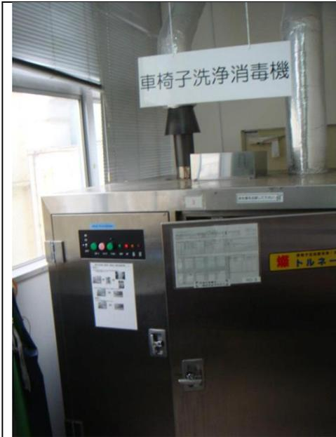
輔具清潔以購入大型器械直接以機器消毒為主，包括輪椅以及電動床的床墊。
