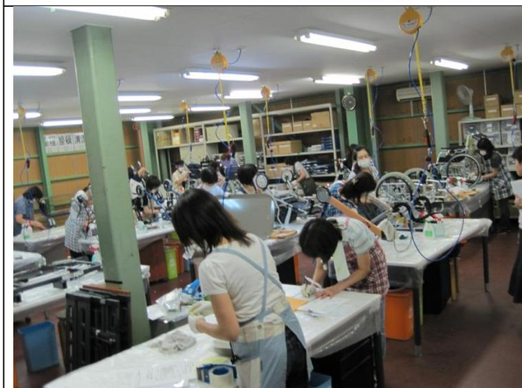
因有些細部零件無法以高壓方式沖洗乾淨，即進入作業室以人力做細部的擦拭。
