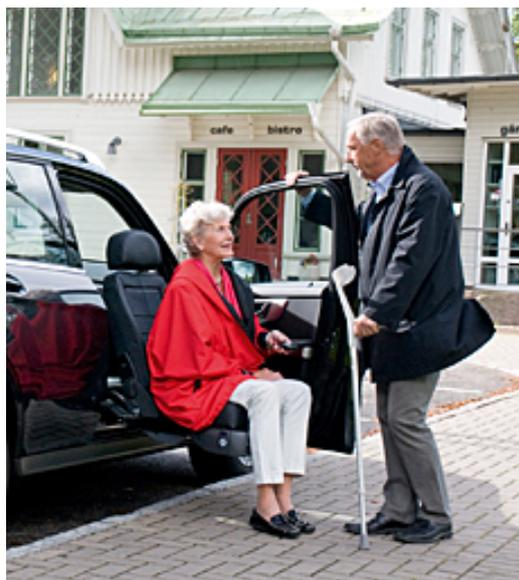
業者還提供了另一種轉向座椅，它除了具有一般轉向座椅的功能外，在原有的座椅上加裝輪子或是加裝輪椅的底座，即可使座椅多了輪椅的功能，省去安裝輪椅升降機的設備，使用者也不需再移位至另一台輪椅上。
