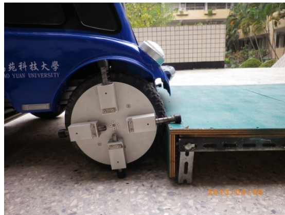
圖二、爬階輪有四根可以伸縮的桿子
