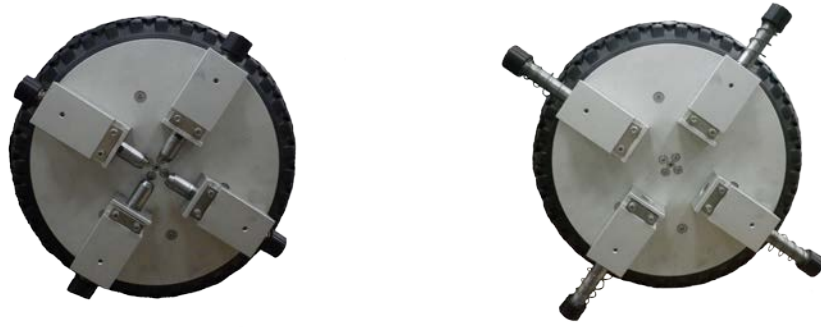
圖二、爬階輪有四根可以伸縮的桿子
