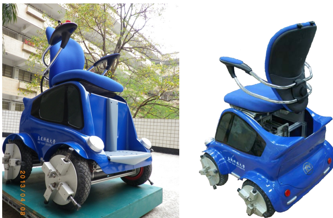
圖五、可跨越階梯障礙之個人行動載具原型成果
