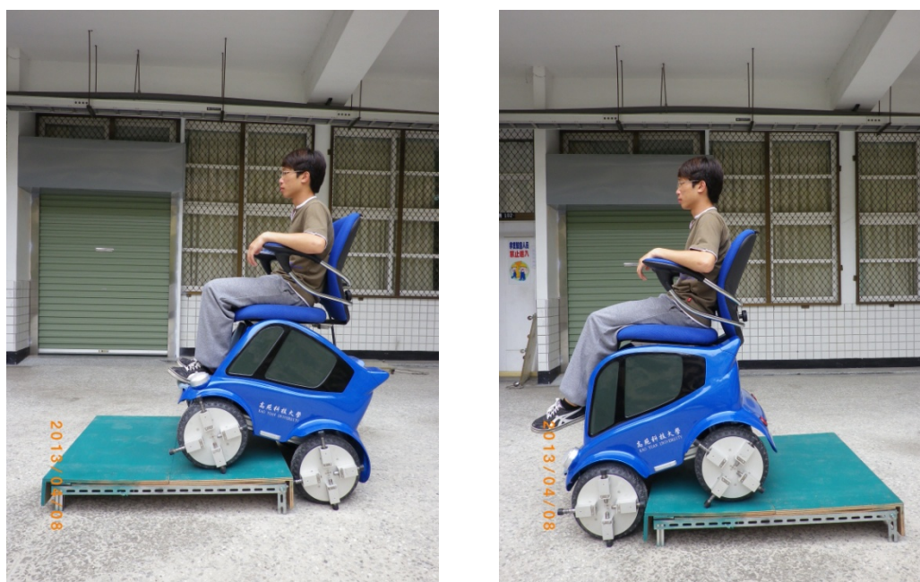
圖四、座位自動調整爬坡角度，使用者可保持水平坐姿
