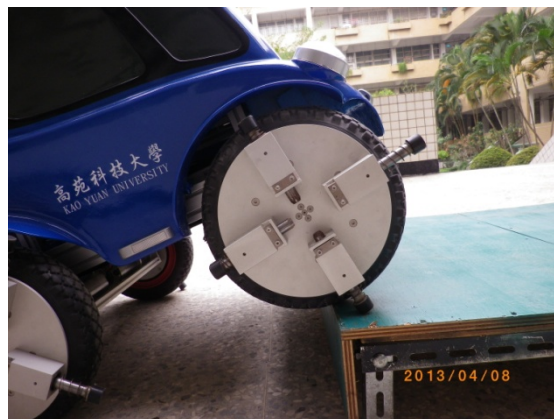
圖三、可跨越階梯障礙之個人行動載具爬階梯實況
