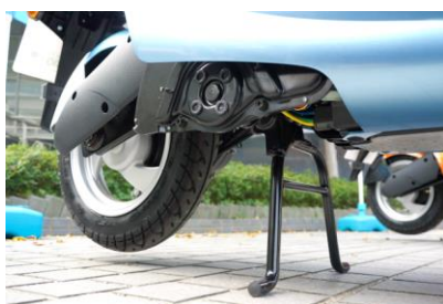
圖 10 電動中柱(柱車架)，以中華 e-moving plus 為例
