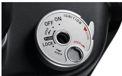
圖 5 中後期加入開坐墊、磁石防盜功能(以 YAMAHA 勁風光 125 為例) 圖 6 近期最多功能，再加免熄火開坐墊、開啟前置加油孔功能(以 YAMAHA CUXI 115 為例)
