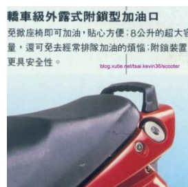
圖 7 早期直覺式設計-加油孔與坐墊都直接以鑰匙開啟(以 YAMAHA 迅光 125 為例)
