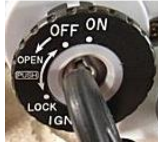
圖 5 中後期加入開坐墊、磁石防盜功能(以 YAMAHA 勁風光 125 為例) 圖 6 近期最多功能，再加免熄火開坐墊、開啟前置加油孔功能(以 YAMAHA CUXI 115 為例)
