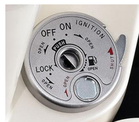
圖 5 中後期加入開坐墊、磁石防盜功能(以 YAMAHA 勁風光 125 為例) 圖 6 近期最多功能，再加免熄火開坐墊、開啟前置加油孔功能(以 YAMAHA CUXI 115 為例)
