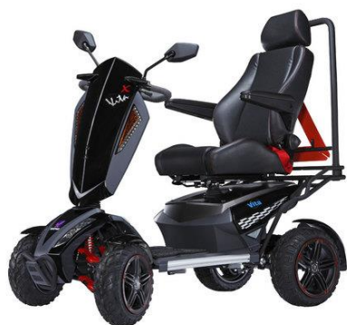
圖 11 新穎外型、椅背大型反光標誌、前斜版與方向燈-以維順 S12X Vita X 為例
