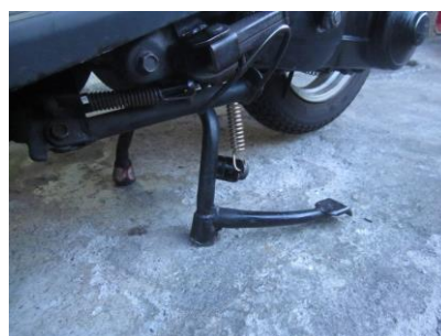
圖 9 自行換裝省力中柱(以筆者家中 YAMAHA 兜風 CT50+踞蹄牌中柱為例)
